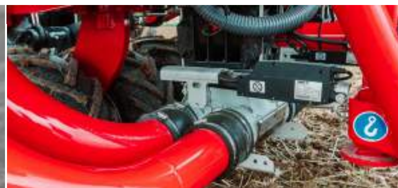
Volitelně elektrické vypínání poloviční šířky umožňuje přesný SectionControl pro lepší práci na souvratí nebo při objíždění překážek
