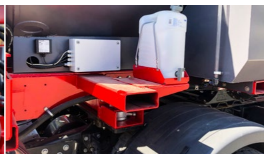
Samostatná nádrž pro umytí rukou
