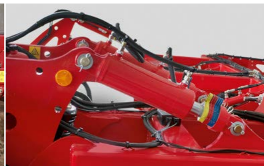
Variabilní nastavení hloubky Hliníkovými podložkami AluClips je možné jednoduše nastavit pracovní hloubku
