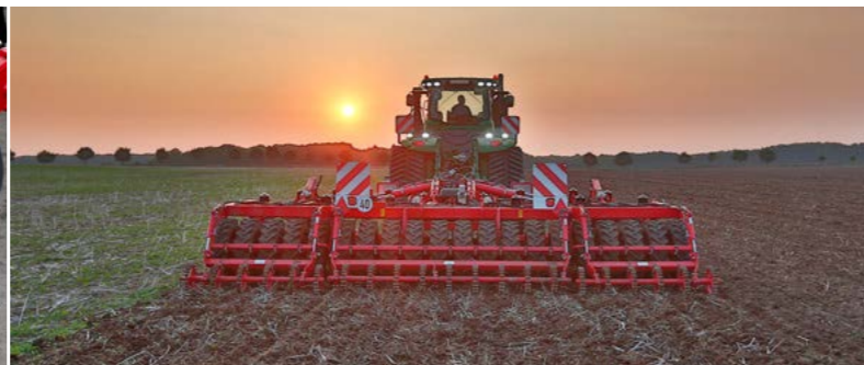
Utužení: Pneumatikový pěch s vysokou nosností, hlubokým utužením půdy a volitelně dodávaným pěchem TopRing pro perfektní povrchovou strukturu
