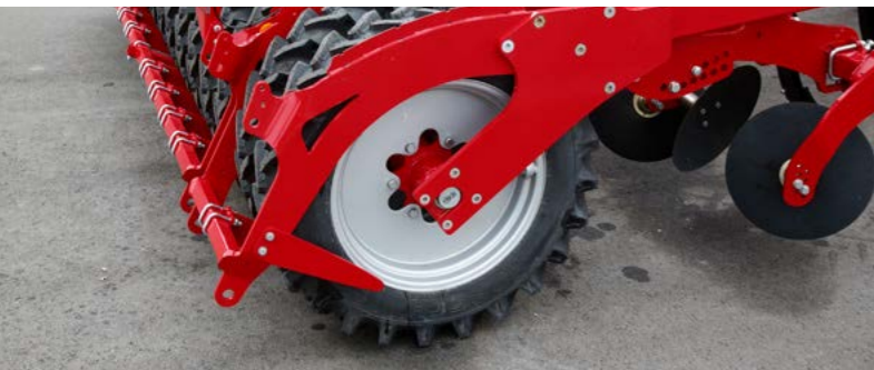
Volitelně velký pneumatikový pěch (průměr 1 m) pro spolehlivou únosnost na lehkých půdách s profilem AS
