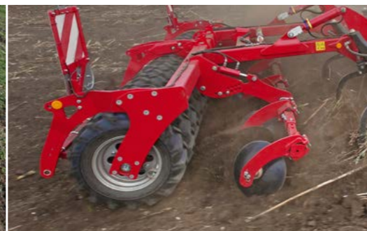
Zaklápěcí talíře Rovnoměrné urovňání před pneumatikovým pěchem
