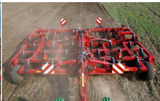
Ochrana proti kamenům Osvědčená mechanická ochrana proti kamenům, volitelně i s hydraulickou ochranou u prvních dvou řad radliček
