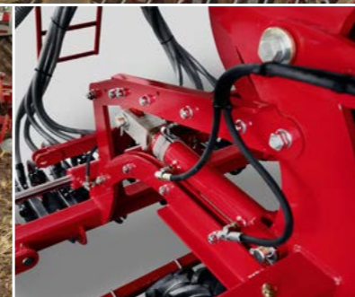
Pronto TD Individuální nastavení hloubky setí pomocí hliníkových podložek AluClips
