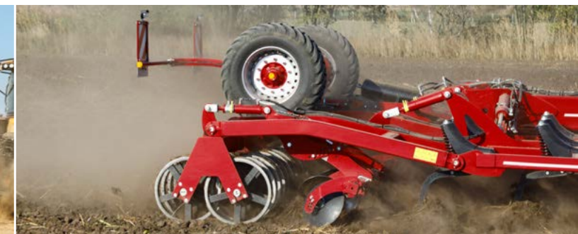
Sklopný podvozek v pracovní poloze
