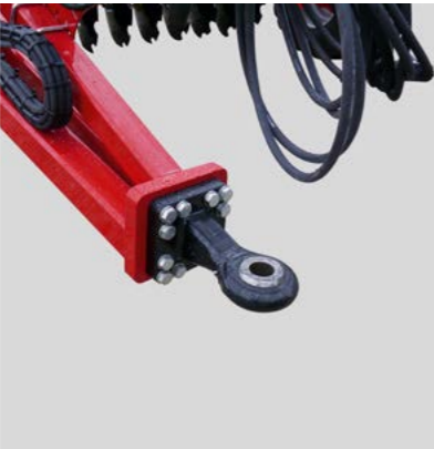
Zapojení do spodního závěsu (kuločep)
