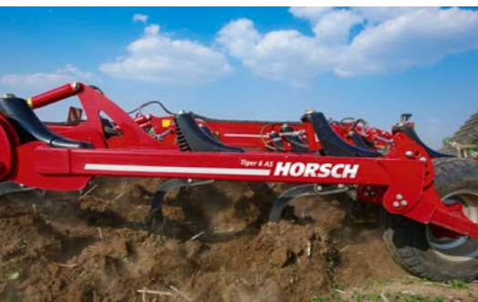
TerraGrip Intenzivní mísení a kypření díky čtyřem řadám pracovních orgánů
