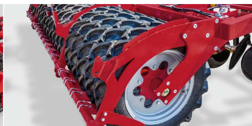
Větší pneumatikový pěch o průměru 24 palců (volitelně)
