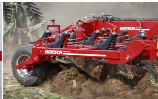
Hydraulické jistění orgánů TerraGrip pro pracovní tuhost až 770 kg (volitelně pro první a druhou řadu radliček Tiger 5, 6, 8 AS)
