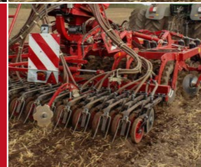
Výsevní lišta s TurboDisc botkami 15 cm roztečí řádků, integrované tlumení secí botky, plynulé nastavení tlaku secí botky do 120 kg/na botku
