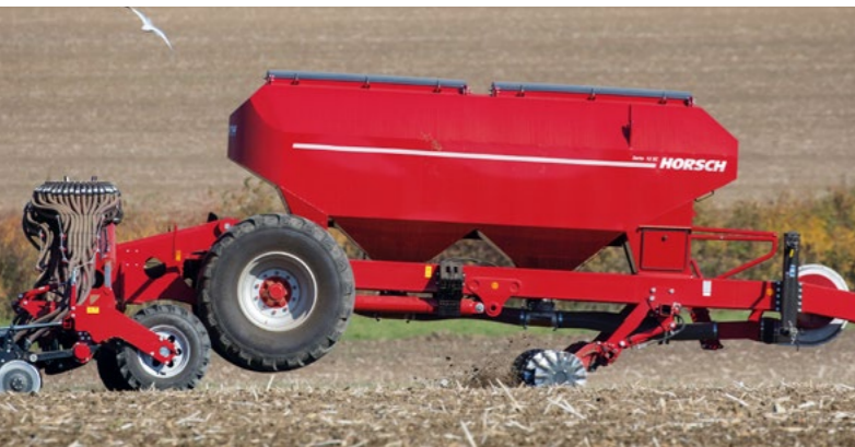
Tlakový zásobník dělený v poměru 60:40 (3 600 l vepředu a 2 400 l vzadu)
