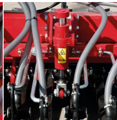
Hydraulické plynulé nastavení přítlaku na botku
