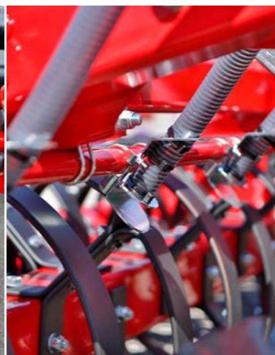
Rozdělovače osiva MiniDrill ukládají osivo přímo do vlhké půdy.
