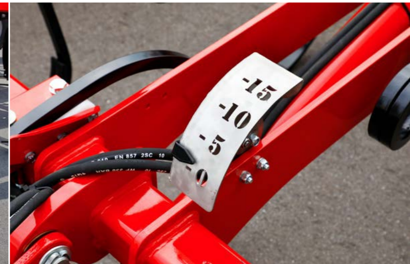
Hydraulické nastavení hloubky
