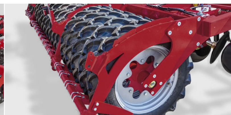
Větší pneumatikový pěch o průměru 24palců (volitelně)
