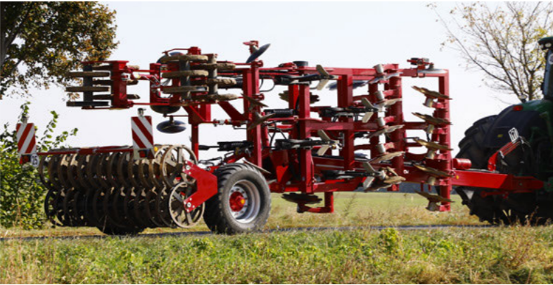
Sklopný podvozek v poloze pro přepravu
