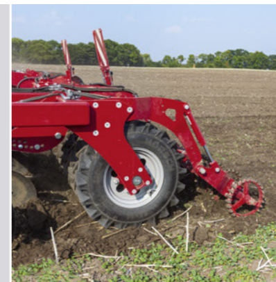
V kombinaci s pneumatikovým pěchem 7.50-16 AS a 210/95-24
