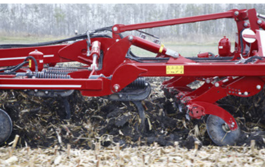
TerraGrip Přidavné promíchávání a kypření pomocí dvou řad radliček
