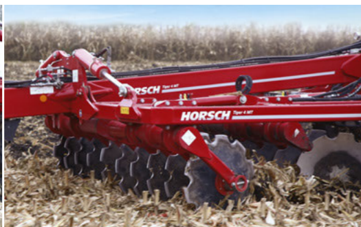
Dvouřadý DiscSystem Rozřezává všechny posklizňové zbytky
