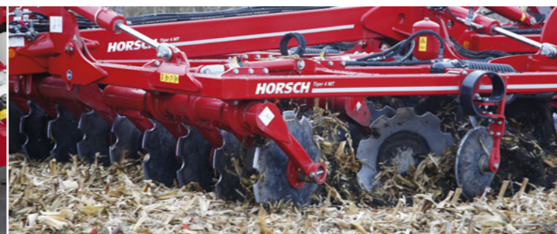
Těžké talíře DiscSystem Dvouřadé uspořádání, průměr talířů 68 cm, rozteč talířů 40 cm, jednotlivé zavěšení, prokrajované okraje
