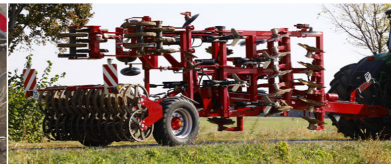
Sklopný podvozek v poloze pro přepravu
