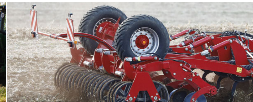
Sklopný podvozek v pracovní poloze
