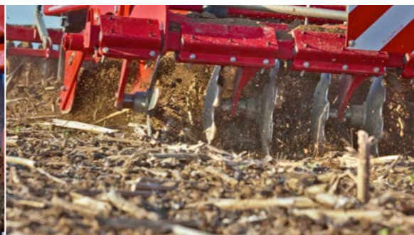
Talířový DiscSystem slouží k mělkému intenzivnímu míchání
