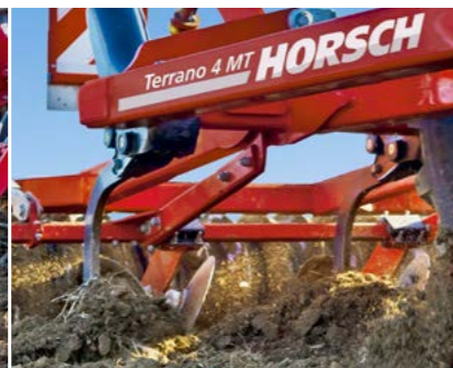
Jednotky TerraGrip s LD radličkami půdu kypří hluboko a bez hroud
