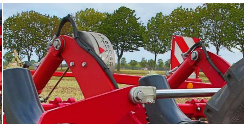
Hydraulické nastavení hloubky radiček
