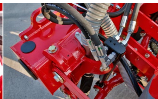
Zavěšení v upínacím profilu umožní snadnou přestavbu z 12 na 8řádek, stejně jako sériově namontované hydraulické válce pro vytváření přítlaku botek
