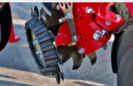
Volitelně lze stroj osadit odhrnovači, kopírujícími vedení hloubky
